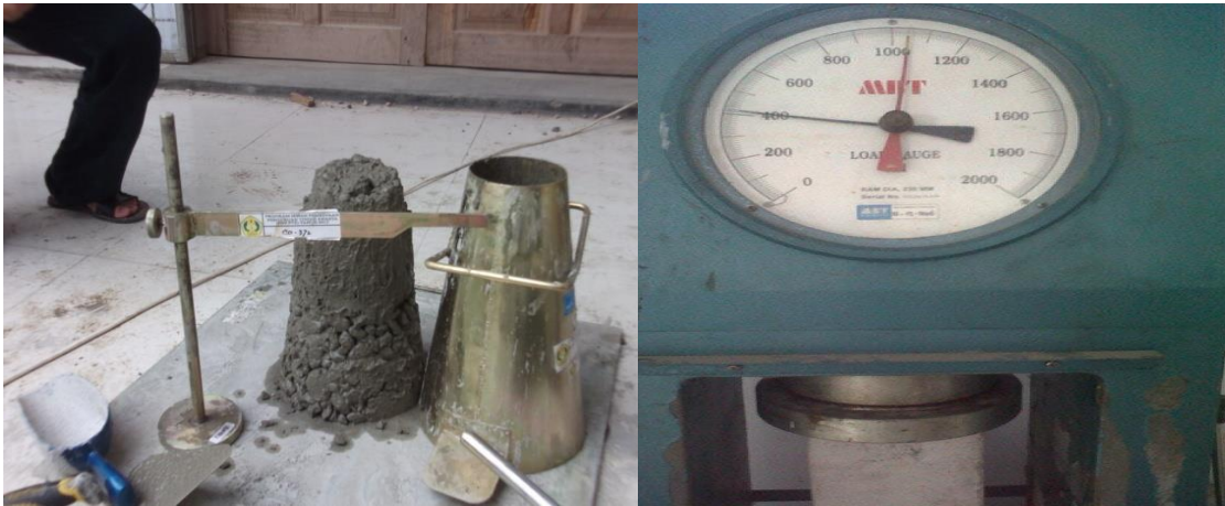
Gambar 1 . Hasil pengujian nilai slump dan kuat tekan
