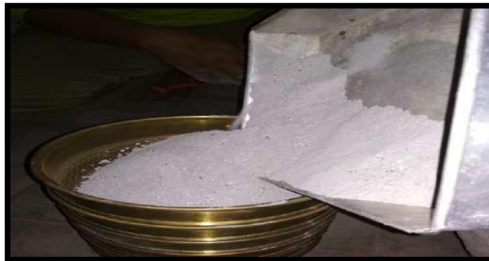
Gambar 3. Proses Pengujian Analisis Saringan Remis
