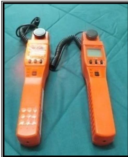
Gambar 1. Alat ukur jenis Meterman LM631 Light Meter
