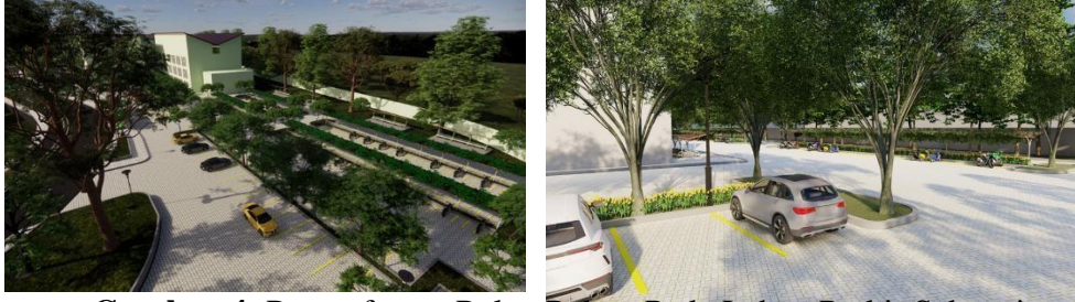
Gambar 4. Pemanfaatan Pulau Pohon Pada Lahan Parkir Sebagai Area Bio-retention swale Fakultas Teknik dan Fakultas MIPA
