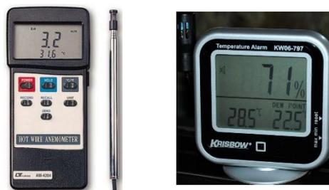
Gambar 1: Alat Ukur Anemometer Hot Wire Merk, Lutron AM-4204 dan Alat Ukur Temperatur dan Kelembaban, merk Krisbow type KW06-797
