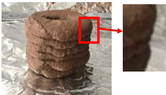
Gambar 6. Visualisasi Error Dimensi Pada Proses Printing Material (sumber : hasil pengolahan data)
