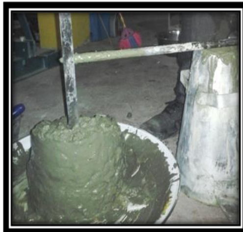
Gambar 4.3 Pengujian Slump dengan Mix Design SNI 03-2834-2000
