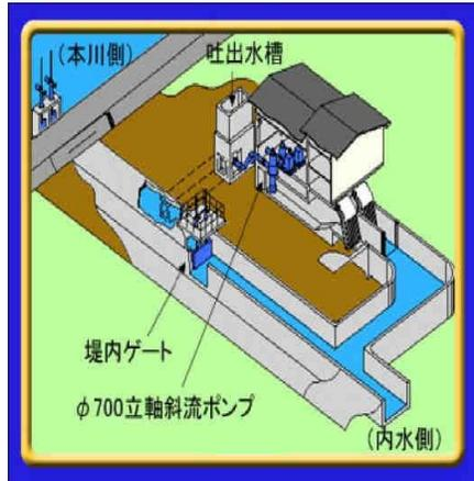
Gambar 2.4. Pompa dan Rumah Pompa
